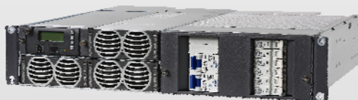
6 кВт в 19" исполнении, 2 RU с контроллером, панелью распределения батарей и нагрузки
